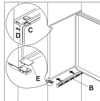
4. Установить вентиляционную решётку (В) и накладку петли (Е), защёлкнув их. Вставить крышки (С-Д) в отверстия петель.
